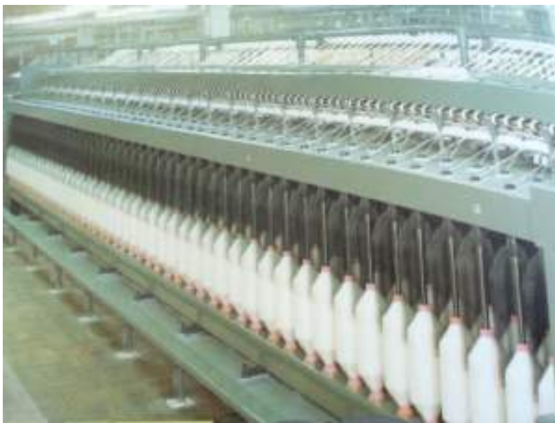
Figura 8 – Máquina de Maçaroqueiras Fonte: Howa ([1980?, p. 1]).
